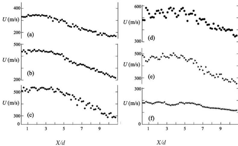
Figure 5. Centerline velocity<sup>16</sup> at  $t =$  (a) 0.30, (b) 0.34, (c) 0.38, (d) 0.42, (e) 0.46, and (f) 0.5.
