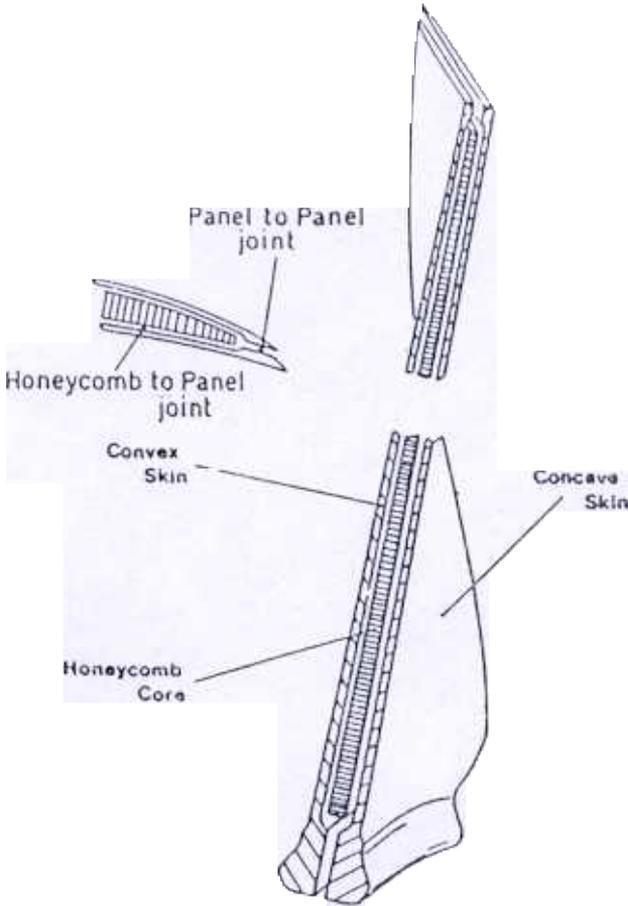
Figure 1. Wide chord fan blade fabrication.
