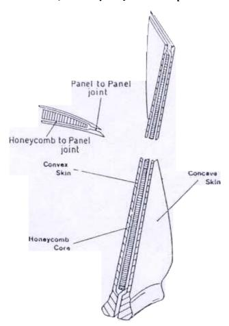
Figure 1. Wide chord fan blade fabrication.
