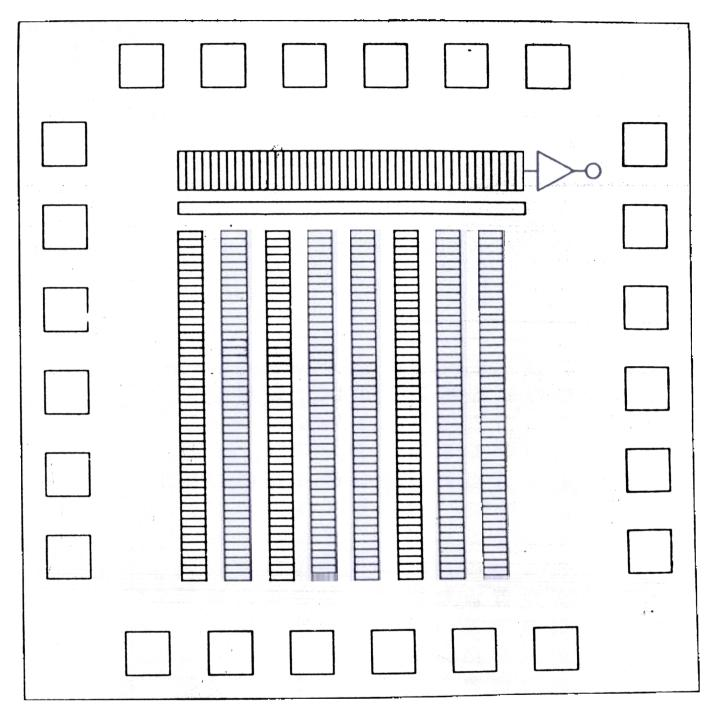
Figure 2. CCD MUX schematic for mini FPA sensor
