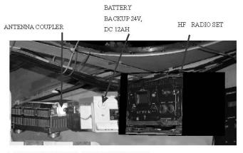
LOCATION OF HF RADIO SET, BATTERY BACKUP, AND ANTENNA COUPLER
