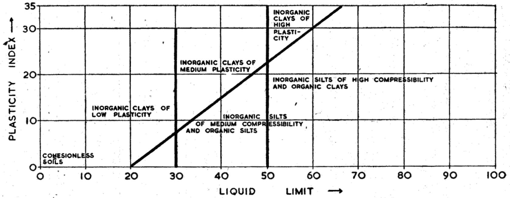
FIG 1 LIQUID LIMIT PLASTICITY INDEX CHART BY A CASAGRANDE
